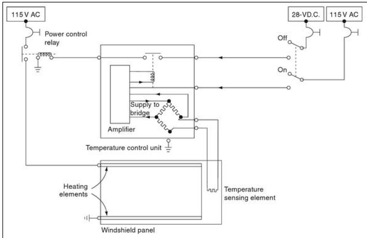
**Figure 1 : schéma du dispositif de dégivrage**
