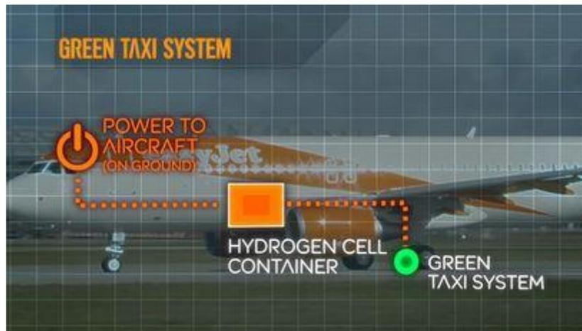
Un concept d'avion hybride dont les trajets au sol seraient alimentés par une pile à combustible a été dévoilé par Easyjet, et mis au point en partenariat avec l'université de Cranfield.
