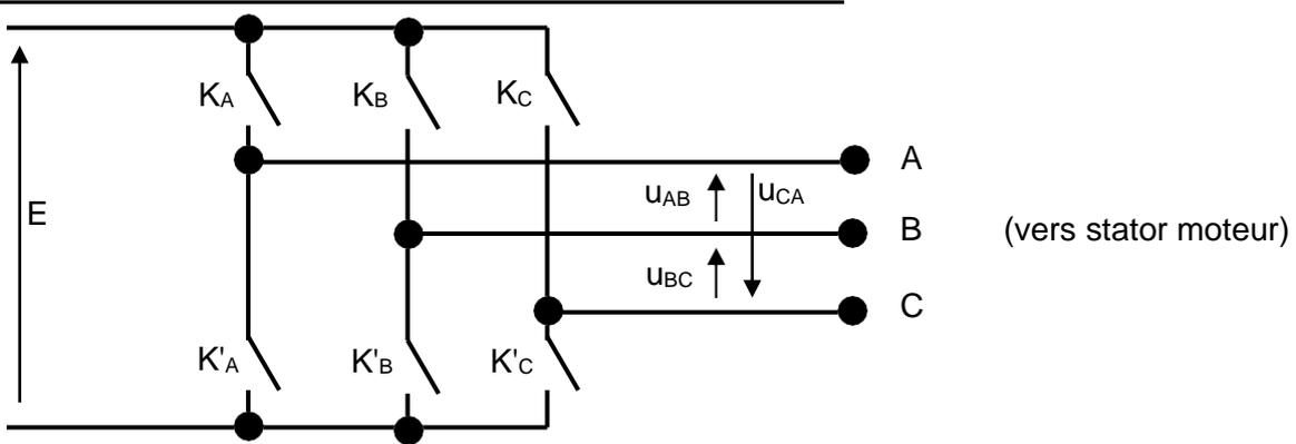
L'onduleur triphasé comprend trois voies (A, B et C), chacune constituée de deux interrupteurs électroniques K et K', commandés de façon complémentaire : lorsque K est fermé, K' est ouvert, et inversement.
