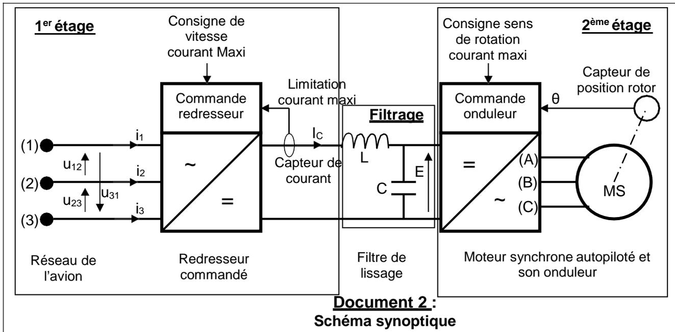
Le premier étage du convertisseur est chargé d'opérer, à partir du réseau de l'avion, une conversion alternatif  $\rightarrow$  continu. Cette conversion, réalisée par redressement commandé, fournit une tension redressée réglable en fonction de la vitesse désirée du moteur (consigne de vitesse).
