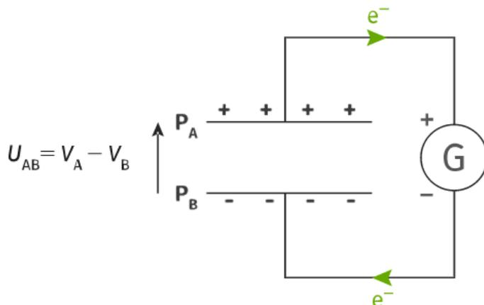
Considérons une particule chargée placée entre les armatures d'un condensateur plan à air. Nous pouvons remarquer que la particule subit toujours la même force en tout point de l'espace situé entre les deux armatures. (la distribution de charge semble identique quel que soit le point considéré dans cet espace.)
