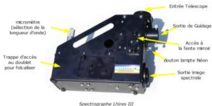
Figure G : Photographie et fonctionnement du spectroscopie Lhires III
