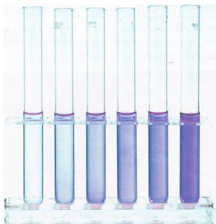
L'intensité de la couleur d'une espèce chimique colorée en solution est liée à sa concentration, ce qui constitue un moyen de détermination de la concentration.
